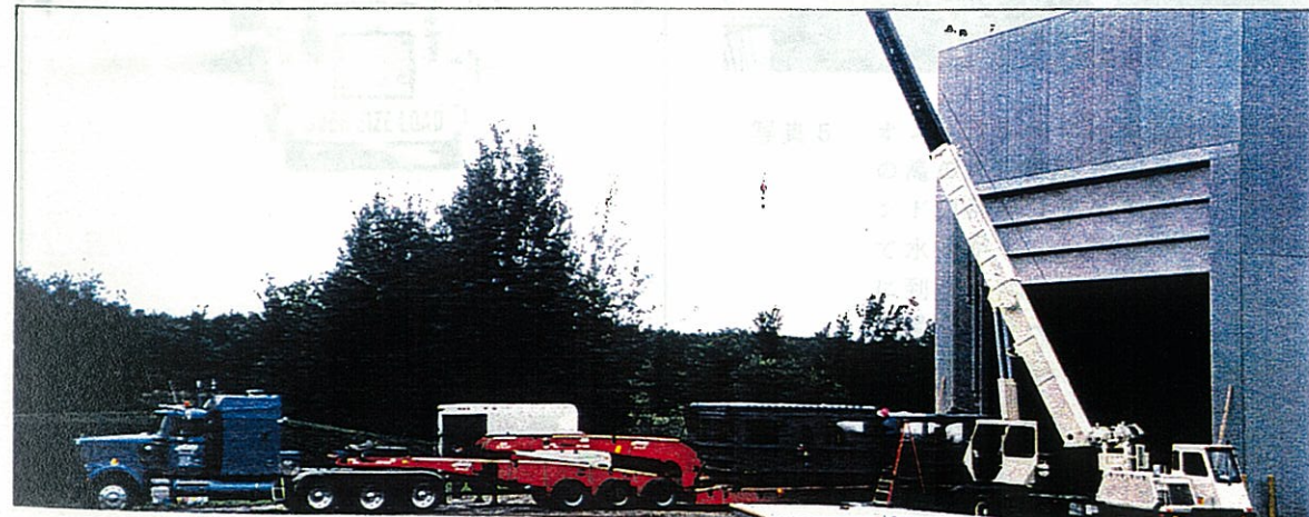
写真3 長さ約40m、13軸のトレーラーに載せられ、出発準備のため工場から引き出されたコンテナ。
