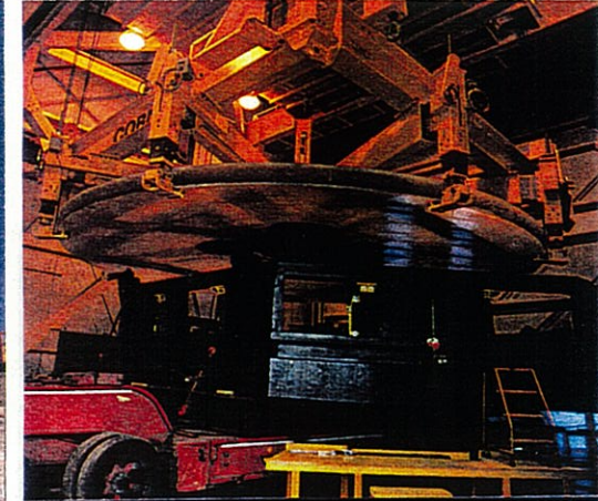
写真2 コーニング社カントン工場内で、運搬用コンテナに吊り込み作業中の主鏡材。下側が研磨されて鏡になる面。
