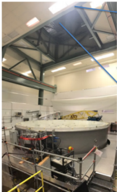
主鏡セルに主鏡を格納して行った光学試験の様子。
