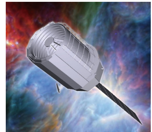
望遠鏡縦置き構成の例(旧SPICA)
