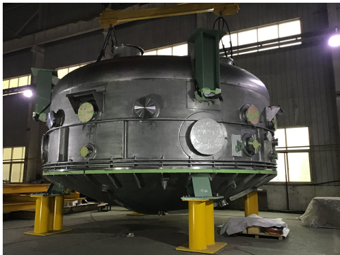
完成し組み立てられた蒸着チャンバー。
