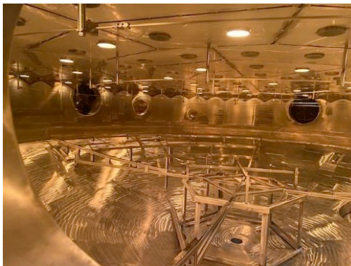
蒸着試験中の釜内部の写真
