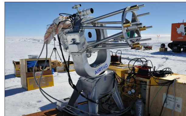
赤外線での空の散乱強度測定
