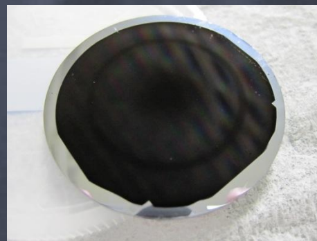
モスアイレンズの 外見 (上) および構造図 (右)
