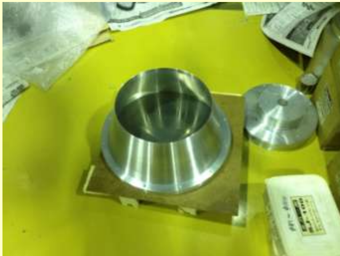
ATCで製作されたバッフル試作品 フランジ外径 \Phi 400
