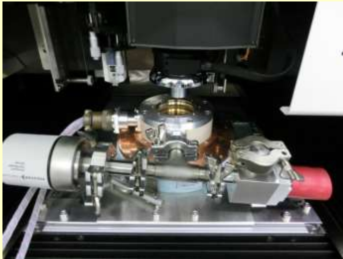
ピンホールグリッド寸法測定用クライオスタットの設計・製作.
