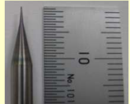
使用工具 超硬合金+TiAlNコーティング
