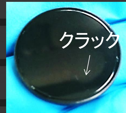
熱サイクルでクラックの入った多層膜干渉バンドパスフィルタ
