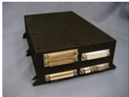
磁気軸受ホイール (駆動回路部)
