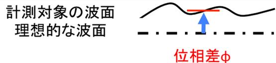
理想的な波面に対する波面の進み/遅れ(位相差)の直接計測
