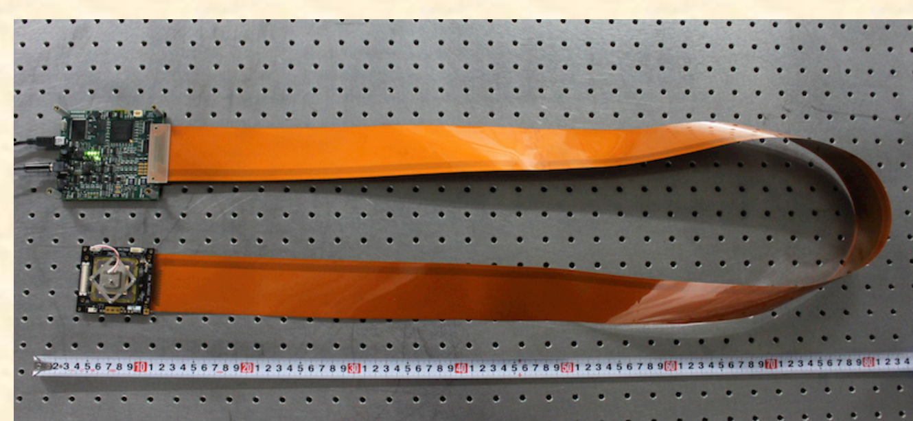
Figure 3: SIDE CAR ASICとJADE2 Cardに接続した新フラットケーブル。
