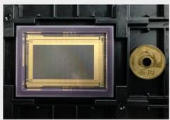
図2 Tomoeに使用するCanon製 35mmフルHD CMOSイメージセンサ。表面照射型。
