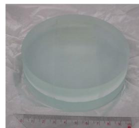
④ 両サイドにもヤトイを、裏面に補強用ガラス板を張り付け、外周丸加工する。
