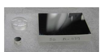
拡大光学系レンズ・折り曲げ鏡・凹面鏡
