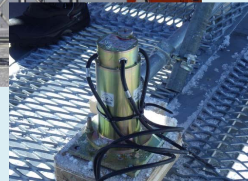
傾斜計による不同沈下の測定 (現在も計測中)
