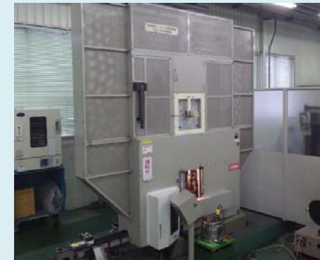
鋼材のシャルピー試験
