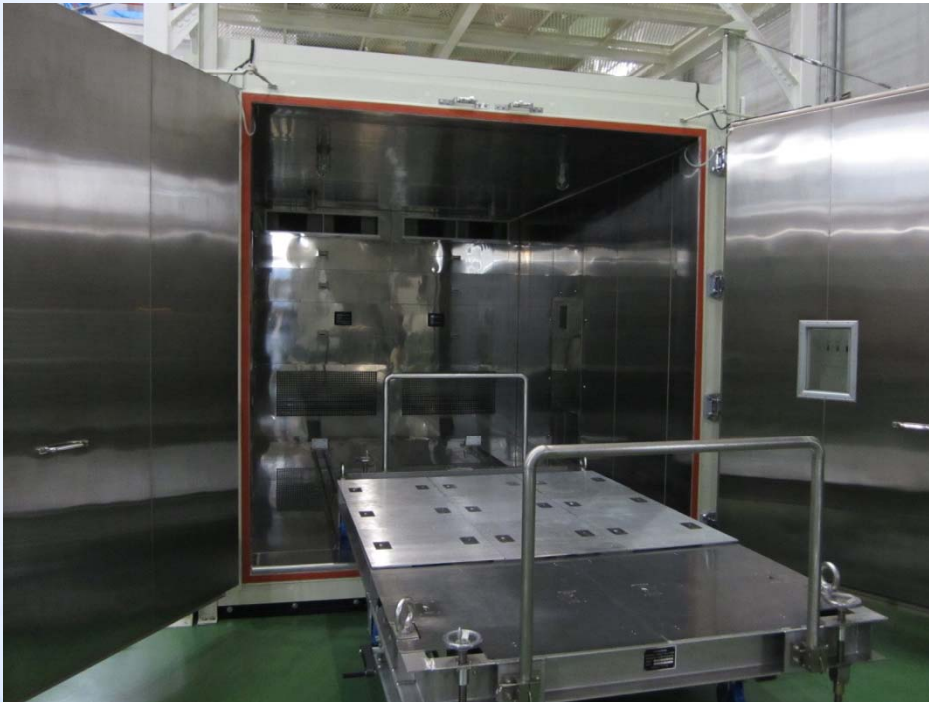
JAXAの大型恒温室 W3m x D4m x H2.6m
