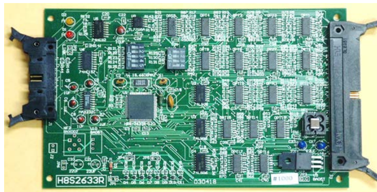
Local Control Unit: LCU の仕様 CPU: H8S2633 I/O: 50 ch / 16 ch. シリアル通信: 3ch. 入出力電圧: 最大30V
