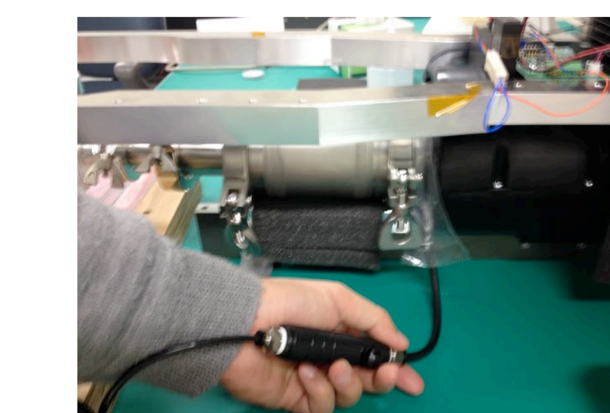
Fig.9. ニトリル製Oリングに交換後に再度リーク試験を行う様子。Oリング部分にピンポイントにヘリウムガスを吹きかけている。
