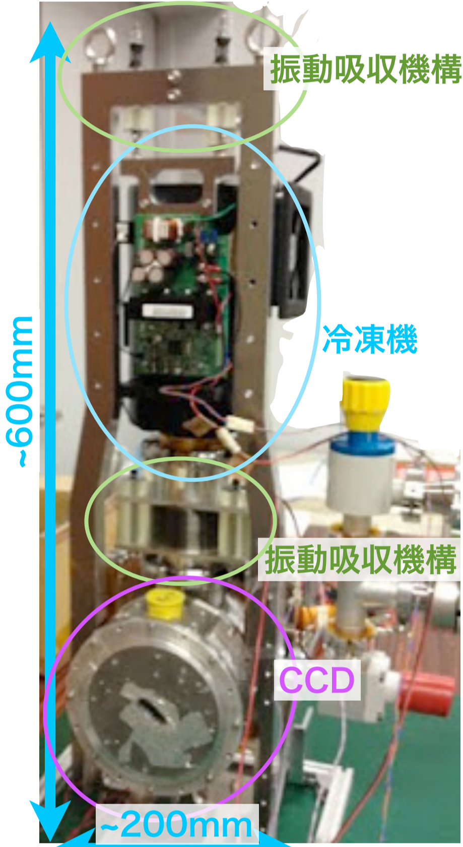
Fig.3. Kyoto 3DII用デューワーの全体像。浜松ホトニクス 2k x 4k 完全空乏型CCDを搭載する。また, 高解像度で面分光を行う装置であり冷凍機の振動の結像への影響を防ぐため振動吸収機構(下写真)を搭載している。
