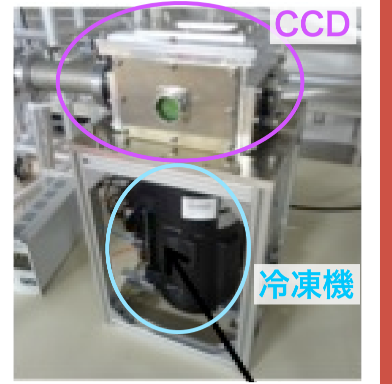
Fig.4. LISS用デューワーの様子。浜松ホトニクス 2k x 4k 完全空乏型CCDを搭載する。振動吸収機構を搭載していないためコンパクトである。
