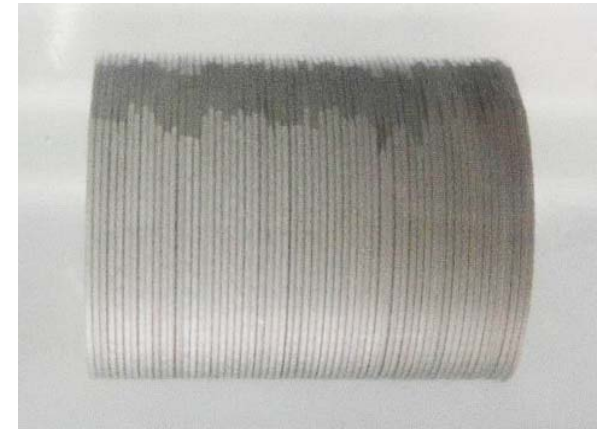
金の常温接合により積層されたミラー基板ブロック
