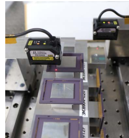
熱伝導両面テープの長期耐久比較試験の様子。結果、3M社8904-02が選ばれる。
