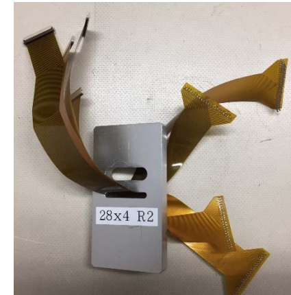
フラットケーブルを通す穴のサイズを検討するための試験機
