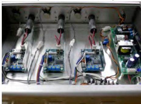
ペリスタポンプコントローラー (細胞シグナル動態研究グループ)
