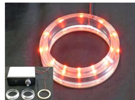
顕微鏡対物レンズ直付け型LED赤外ユニット (行動神経生理学研究チーム)
