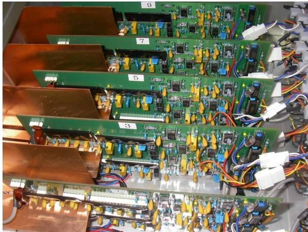
電子回路：増幅器 (製作期間/研究室：2ヶ月, 牧島宇宙放射線研)
