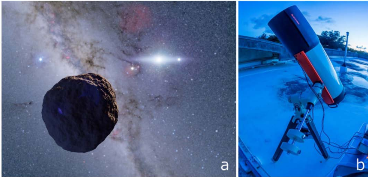
[図1] (a) 本研究によって史上初めて発見された、微惑星の生き残りと推定される半径約1.3kmの小型カイパーベルト天体の想像図。(b) 巨大望遠鏡でも直接観測不可能な小型カイパーベルト天体を発見した宮古島の口径28cm小型望遠鏡 (OASES観測システム)
