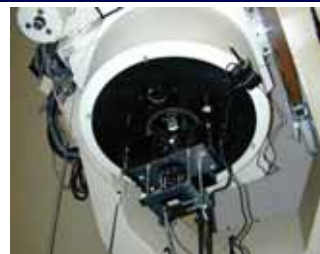
図4. 望遠鏡取り付け時の偏光装置
