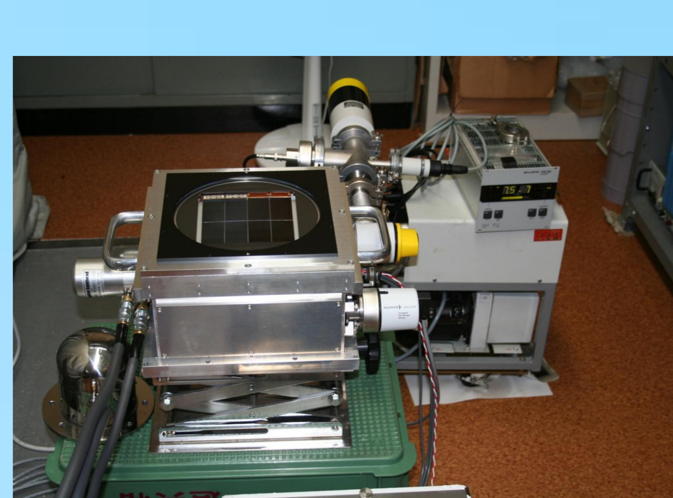
デューの真空冷却試験システム 木曾観測所にてデューの真空冷却試験を行っている。
