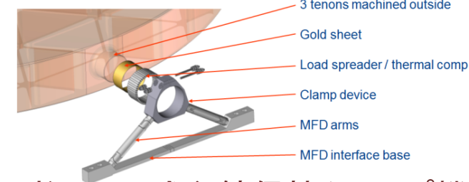
円柱テノン式主鏡保持クランプ機構 設計、解析と試作・冷却試験
