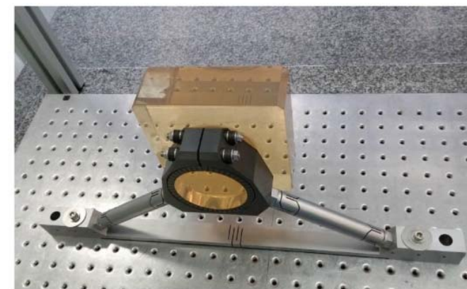
円柱テノン式主鏡保持クランプ機構 設計、解析と試作・冷却試験
