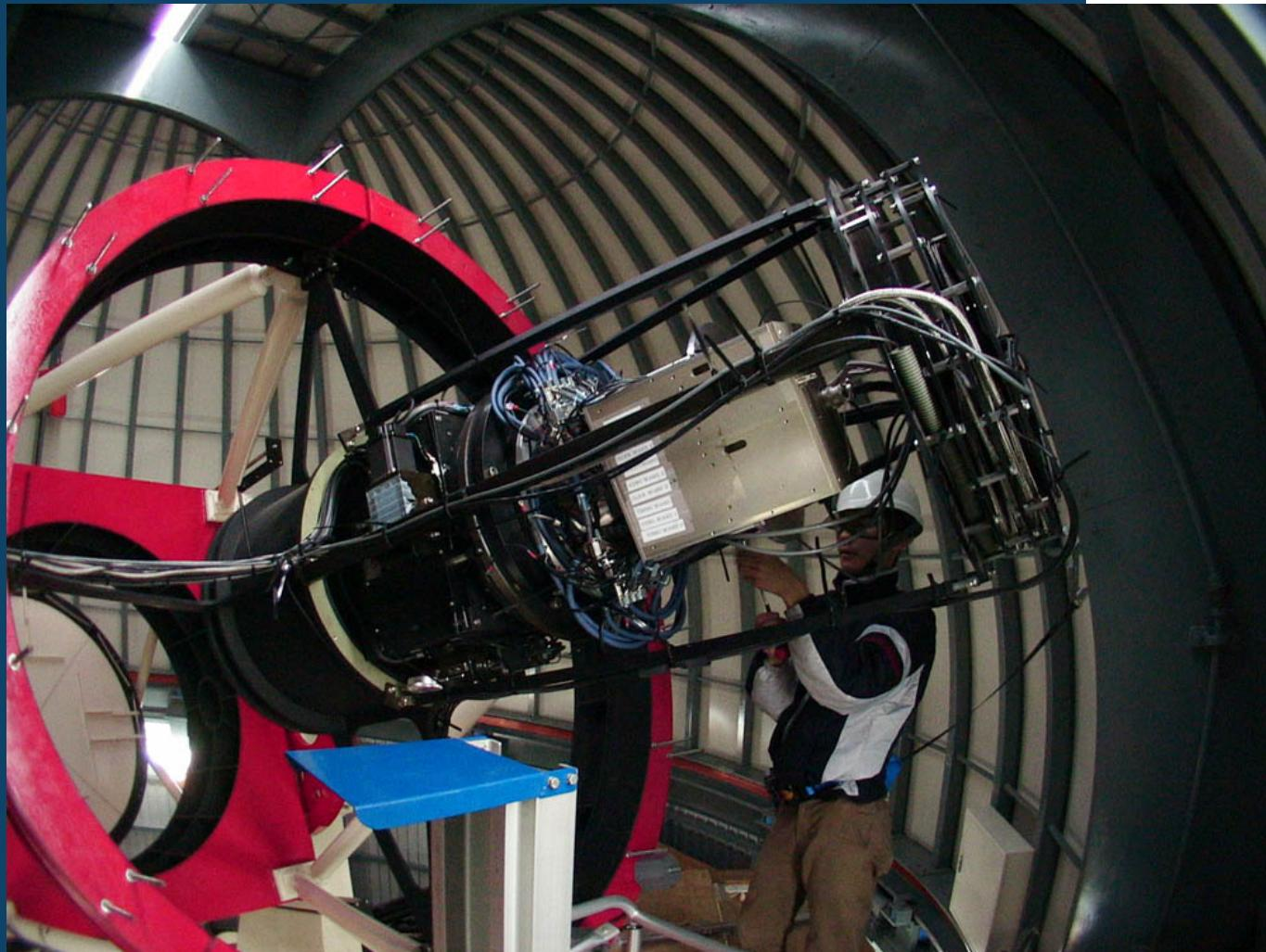
冷えない。60Hz->50Hz 冷凍機をアップグレード
