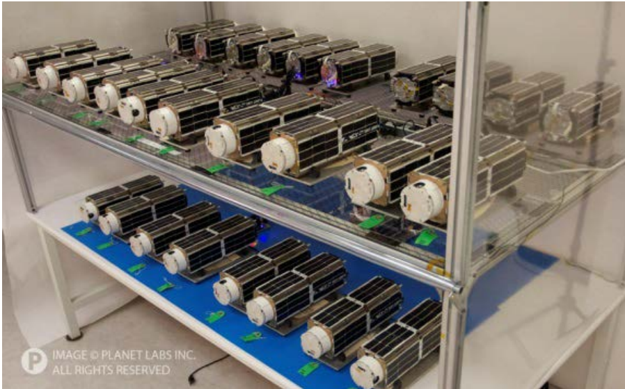
Planet Labsによる3Uでの地球リモセン すでに150機打ち上げ済み
