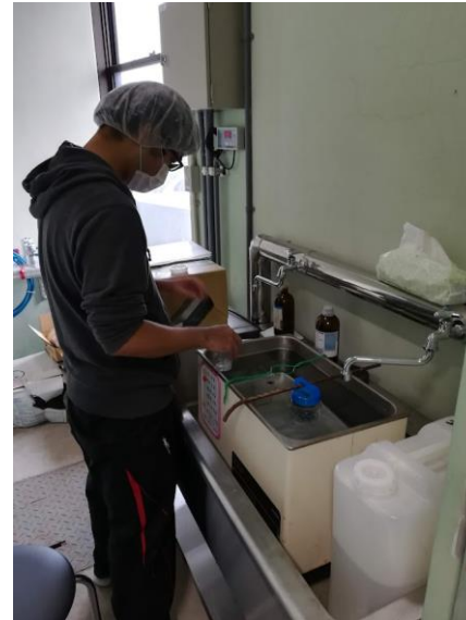
2018年9月 広島大かなた主鏡再蒸着プリウエット作業@ 国立天文台岡山分室 74ドーム
