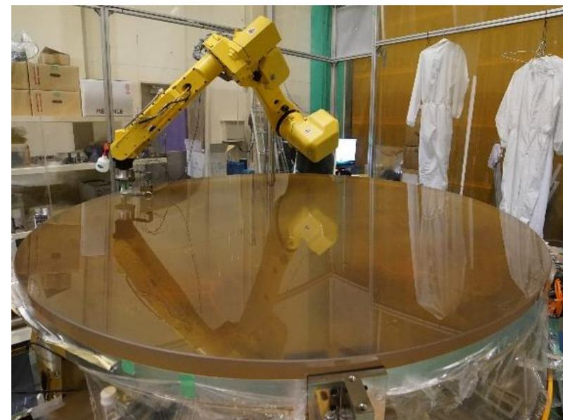
2mまで加工可能なロボット研磨計測機
