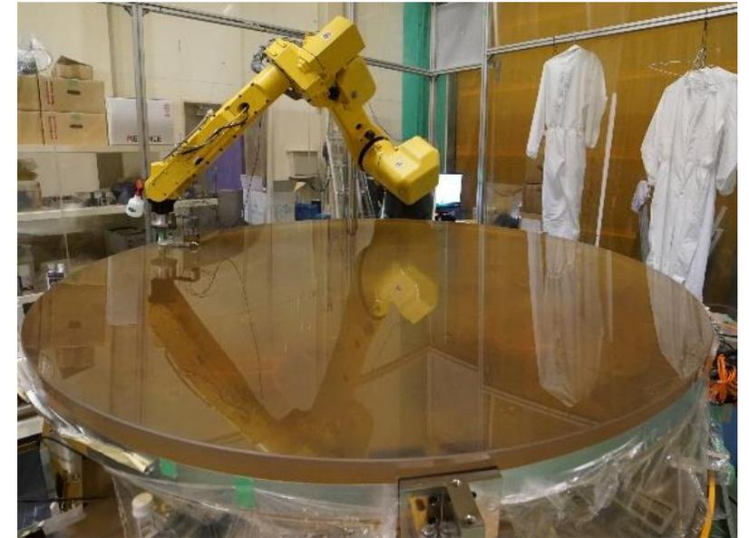
2mまで加工可能なロボット研磨計測機
