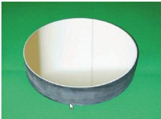
世界初の30cmゼロ膨張セラミック鏡
